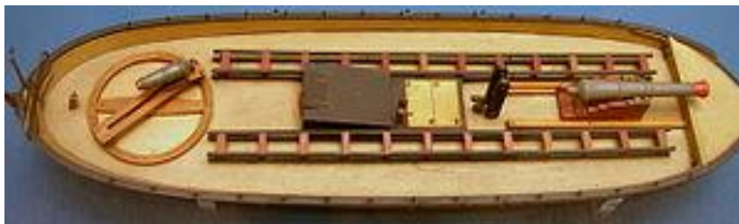
Maquette d'une canonnière de 1808 équipée d'un canon de 24 livres à l'avant et d'une caronade à l'arrière. National Maritime Museum, Londres – Source : © Rémi Kaupp, CC-BY-SA , Wikimedia Commons
